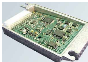
Motoryzacja - mocowanie obwodów drukowanych w obudowach
